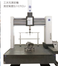
三次元測定機 測定精度0.1ミクロン
