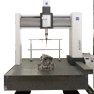
三次元測定機 測定精度1ミクロン
