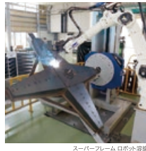
スーパーフレームロボット溶接
