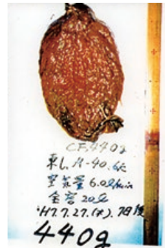
写真2 汚泥が大量固着した炭素繊維
