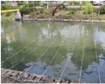
写真4 中国蘇州の水路に設置した炭素繊維
