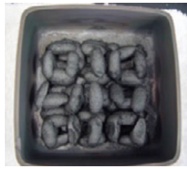
図2 電子レンジで作った繭炭
