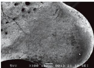
図4 レーザー照射して融けたスレート
