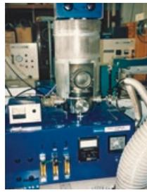
図4 低温プラズマ処理装置
