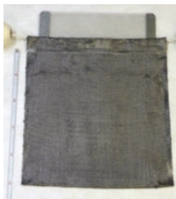
図1 炭素繊維織物袋に鉄網を差し込んだモノ
