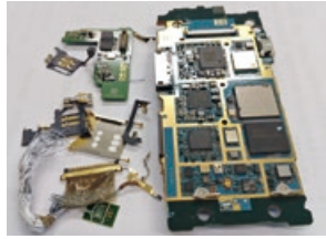
図2 解体したガラ携帯電話
