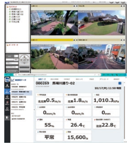
図3 カメラ映像と環境センサ情報の表示例
